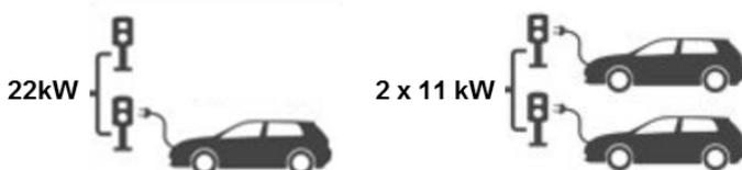
Abbildung 15-21: Schema integriertes Lastmanagement (Quelle: mobilityhouse.com)
