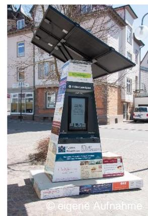
Abbildung 6-33: Fahrrad-Lademöglichkeit inkl. PV-Nutzung
