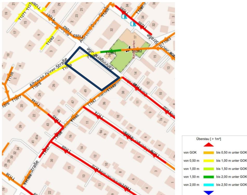
Überstausituation im Bestand, Bemessungsregenereignis T = 2a, D = 90 min (Quelle: Wald + Corbe 2018, Stellungnahme zur Auswirkung des Bauvorhabens auf die hydraulische Belastung des Regenwasserkanalnetzes)
